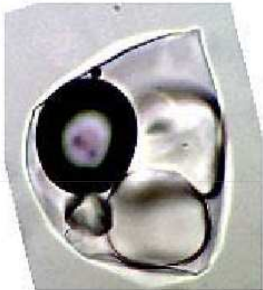
Figura 4. 16. Inclusiones fluidas con varias fases desmezcladas. La temperatura a la que se consigue que la inclusión se vuelva homogénea (una sola fase) es la temperatura que reinaba cuando la inclusión se formó.
