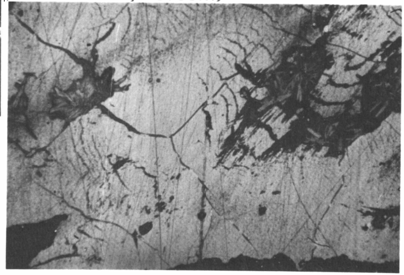
FIG. 4-37 (Continuación) (C) Bandas de difusión mostradas por ágata. Obsérvense también las características de relleno en la parte central. Localidad desconocida. \times 17 . (Foto de W. J. Crook.)
