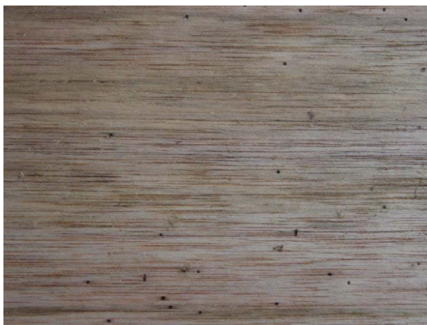
Madera de cedro con ataque de insectos de madera verde y hongos de pudrición blanca en bolsas
