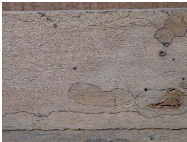
Pudrición blanca en madera latifoliada. Note las líneas negras de compartimentalización
