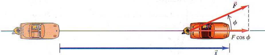
6.2 Cuando una fuerza constante \vec{F} actúa con un ángulo \phi relativo al desplazamiento \vec{s} , el trabajo realizado por la fuerza es (F \cos \phi)s = Fs \cos \phi .
