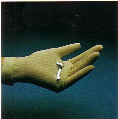
17.17 El metal galio, que vemos aquí fundiéndose en la mano de una persona, es uno de los pocos elementos que funden cerca de la temperatura ambiente. Su temperatura de fusión es de 29.8^\circ\text{C} y su calor de fusión es de 8.04 \times 10^4 \text{ J/kg} .
