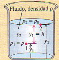
Fluido reemplazado por un cuerpo de forma idéntica: experimenta la misma fuerza de flotación
